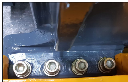
Mast 固定 Bolt
