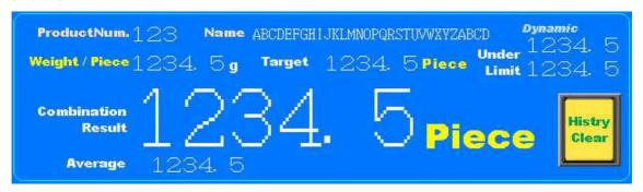
個数換算動作 Mode 時は、上の画面の様に work 1 個当りの重量(単重)を表示し、「目標値」「計量値」の単位が「個」に変わります。
