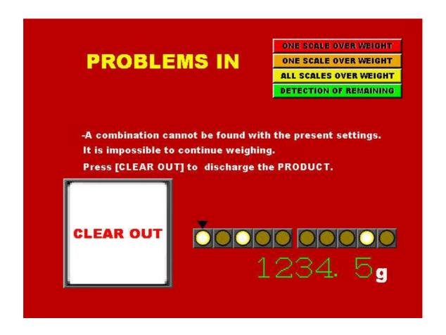
異常 work は不良計量として排出されます。異常計量は次の4種類あり、画面上部の各異常に対応した lamp が点滅します。また、異常が起こった計量器を画面下の lamp で表示します。
