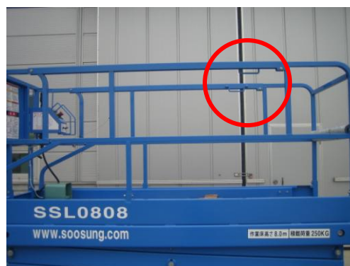
(安全帯取付手すり)
