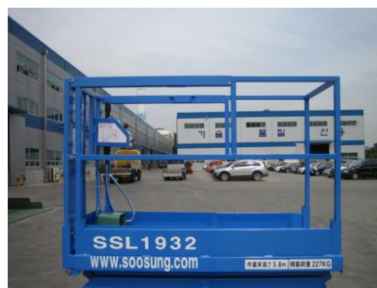
(安全帯取付手すり)
