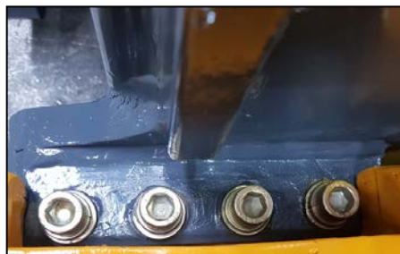
Mast 固定 Bolt
